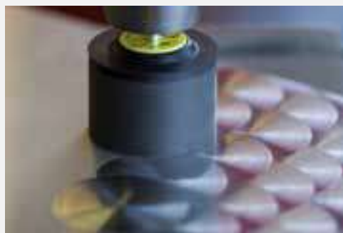
Exemplu de șlefuire decorativă cu corpul marmorat R-Flex SFM 656 pe o placă din oțel inoxidabil
