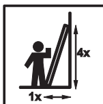
Prawidłowy kąt nachylenia Correct erection angle
